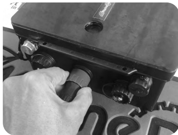
バッテリーに電動ジェットフィンのケーブルを接続
